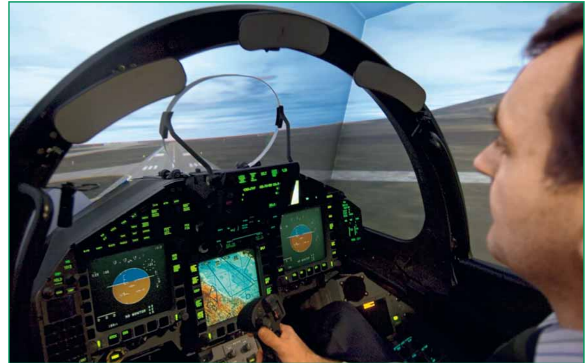
Landeanflug im Cockpit-Trainer. Auch diese einfachere Variante kann über ein WAN (Wide Area Network) vernetzt an einem Übungsszenario als beteiligter Eurofighter teilnehmen
