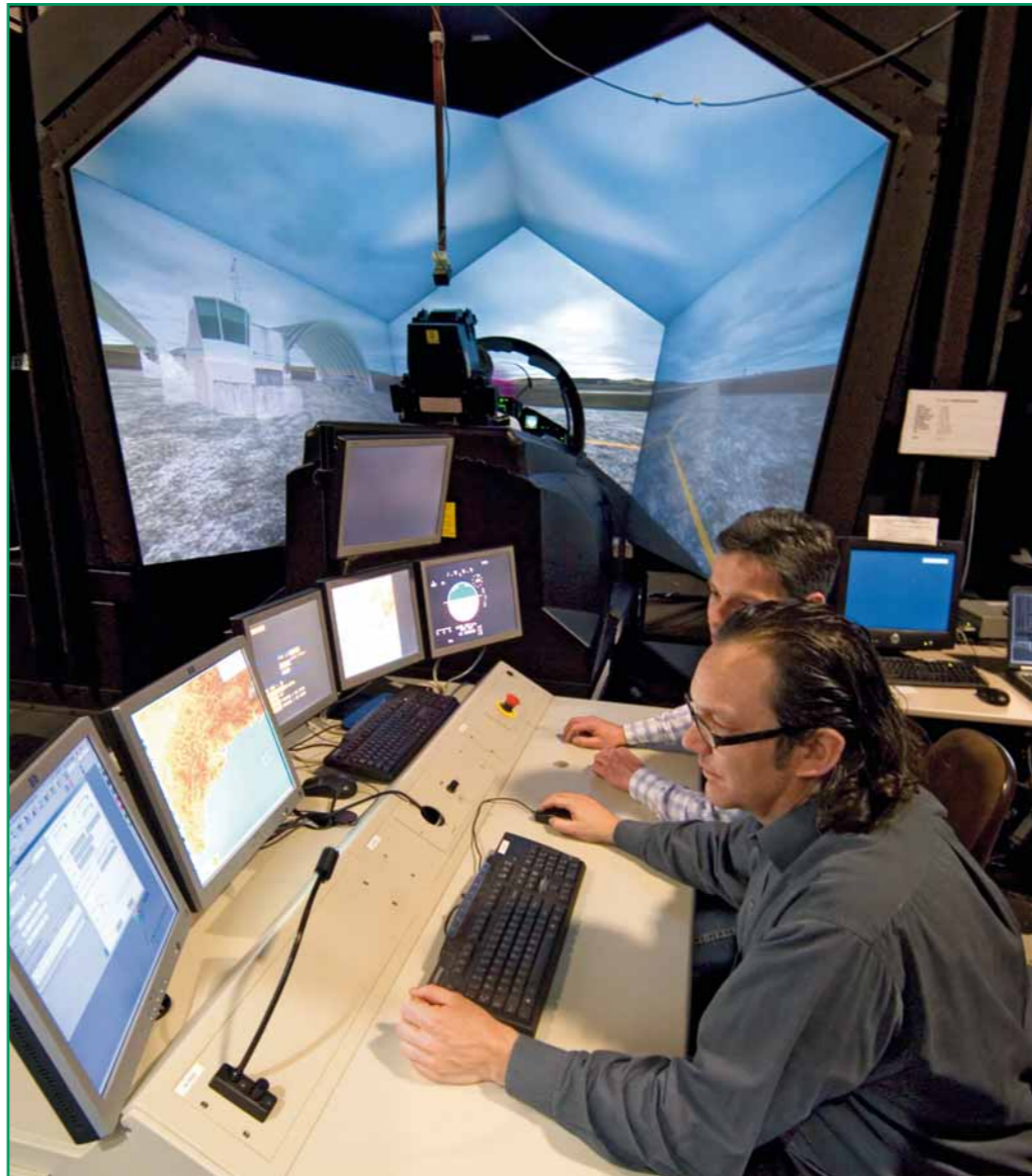
Die Instruktorstation des Cockpit Trainers. Er dient hauptsächlich zur Basiseinweisung auf den Eurofighter und die Einweisung in Notverfahren
