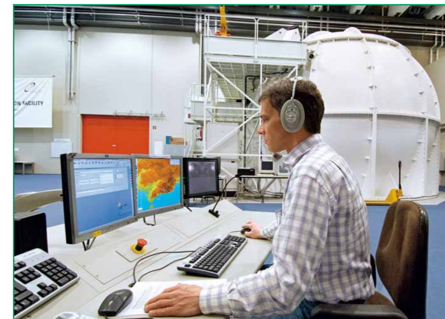
Die Instruktorstation des FMS. Hier können simulierte Missionen geplant – oder der Pilot mit einem unerwarteten Triebwerksausfall konfrontiert werden
