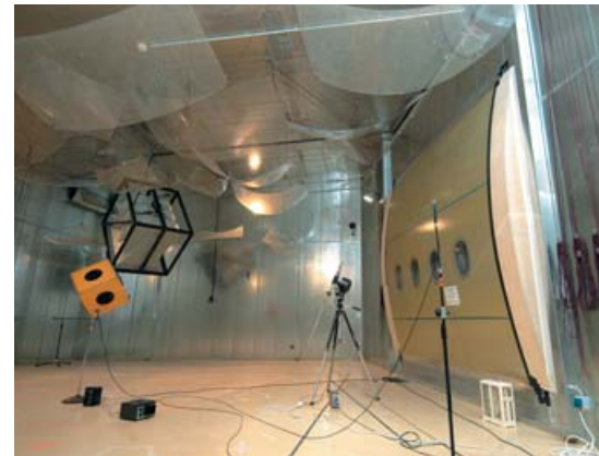
Das Akustiklabor des Cabin Test Center. Rechts ist die Außenhaut eines A380-Rumpfsegments zu sehen, die hier auf ihre akustischen Eigenschaften geprüft wird
