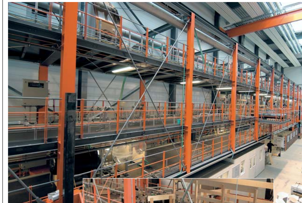
70 Meter Länge, drei Stockwerke: In diesem neig- und kippbaren Gerüst ist das Waste & Water-System der A380 installiert. Die Frischwassertanks aus CFK (kleines Bild) sitzen im Flügelkasten des Giganten in der Rumpfmittle
