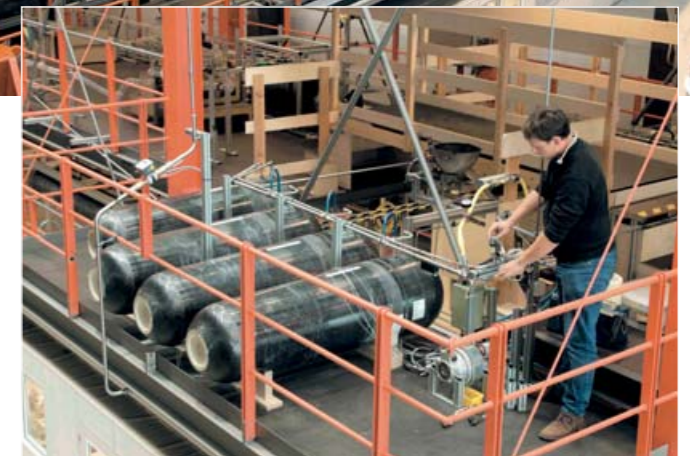
70 Meter Länge, drei Stockwerke: In diesem neig- und kippbaren Gerüst ist das Waste & Water-System der A380 installiert. Die Frischwassertanks aus CFK (kleines Bild) sitzen im Flügelkasten des Giganten in der Rumpfmittle
