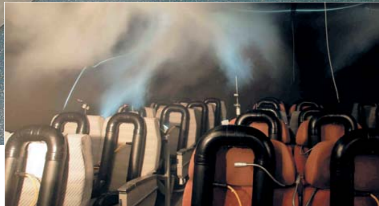
Simulierte Langstreckenflüge samt Ansagen, Boarding und Catering: Im stählernen Mock-up eines A380-Rumpfsegments werden die Kabinensysteme in ihrem Zusammenspiel getestet. In einem anderen Rumpfsegment simulieren Dummies die Körpertemperatur der Passagiere und deren Einfluss auf die Luftströmungen in der Kabine
