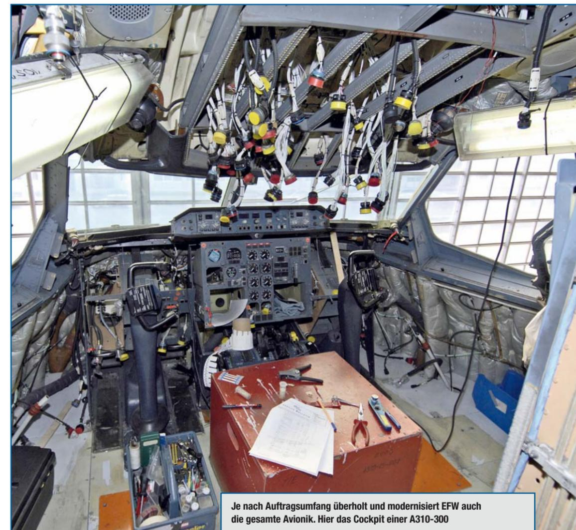
Je nach Auftragsumfang überholt und modernisiert EFW auch die gesamte Avionik. Hier das Cockpit einer A310-300
