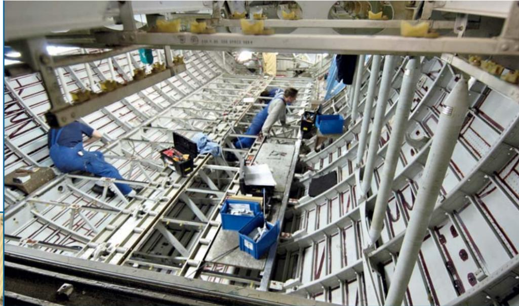
Die vertikalen Streben werden zur Verstärkung des oberen Decks eingebaut
