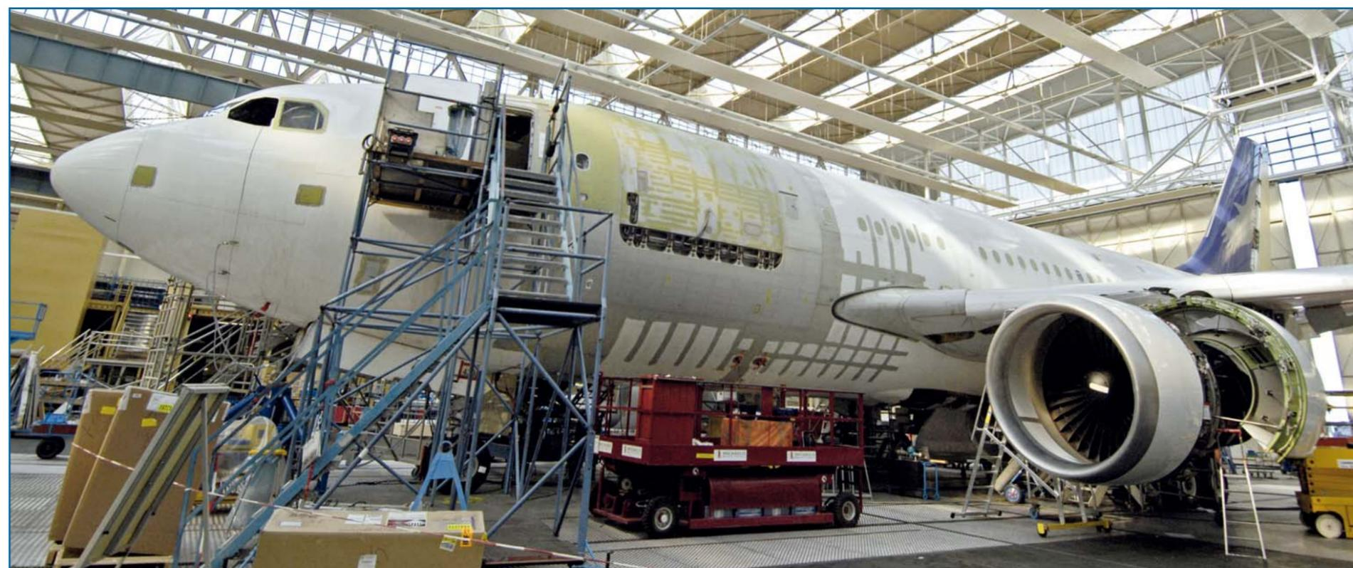
Fast fertig: Diese A310-300 wird bald für Federal Express Fracht befördern. Die neue Grundierung zeigt an, wo die genietete Struktur der Maschine verstärkt werden muss. Rechts von der Montagetrepppe das neu eingebaute Frachttor am Hauptdeck
