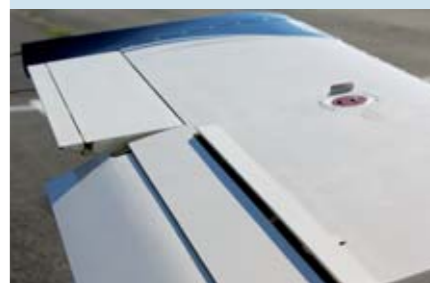
Spoiler auf der Flügeloberseite unterstützen die kurzen Querruder
