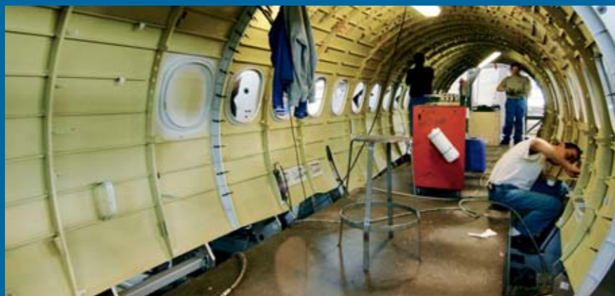
Für die Embraer-Verkehrsflugzeuge der Typen ERJ 170 & 190 werden in Tarbes Rumpfsegmente montiert, für ATR baut Socata Triebwerksverkleidungen
