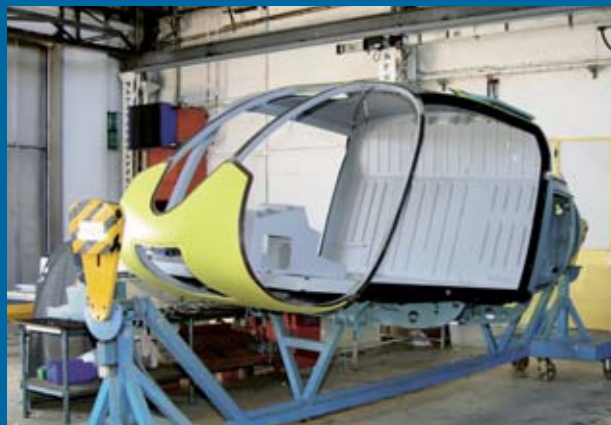
Socata baut Kabinen für Eurocopter-Hubschrauber der Modellreihen EC 130 und AS 350, Türen für die AS 365 Dauphin sowie den Kabinenboden für die AS 332
