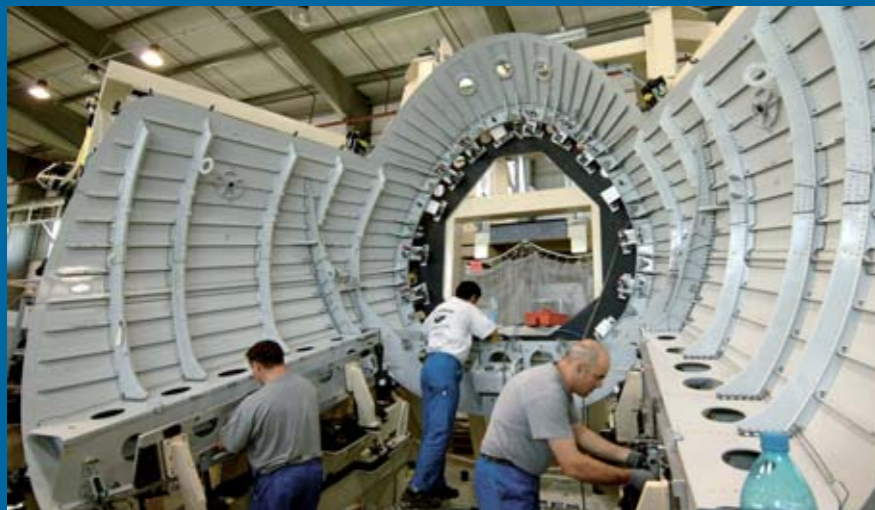
Auch am Bau der A380 ist Socata beteiligt. Das Unternehmen baut das untere Bugteil für den Megaliner sowie die Fahrwerkstore des Bugrads. Auch Teile für den Militär-Airbus A400M werden hier entstehen
