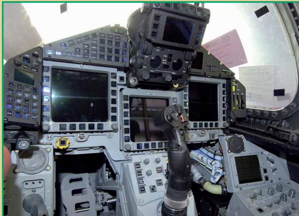
Das Hightech-Cockpit des Eurofighter mit drei Multifunction Color Displays und Head-up Display (oben). Unten: Auf Station 6 wird die nun komplett installierte Avionik auf Herz und Nieren geprüft
