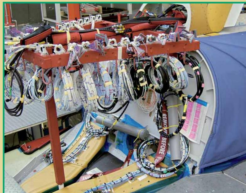
Die Ausrüstung der aus Augsburg angelieferten Rumpfmittelteile erfolgt in einer eigenen Montagelinie ebenfalls in Manching. Der Hilfsrahmen (orange) hält die Kabel, die später im Rumpfvorderteil und Cockpit verlegt werden
