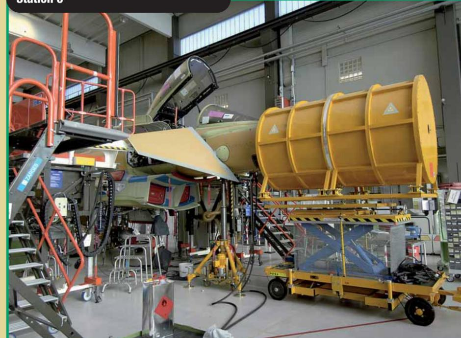
Test des Radarsystems. Zum Schutz der Techniker steckt das Radom in einer Radar-Absorberkammer
