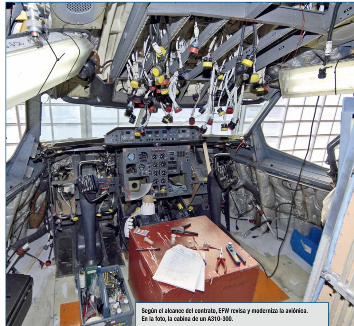
Según el alcance del contrato, EFW revisa y moderniza la aviónica. En la foto, la cabina de un A310-300.
