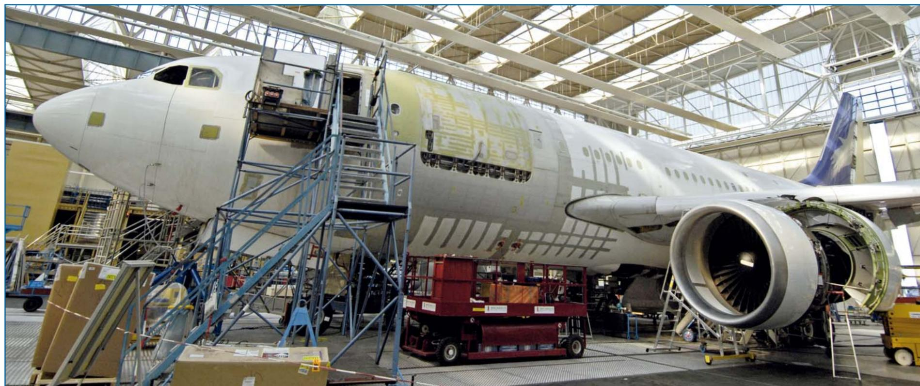
Ya está casi listo: El A310-300 transportará ya pronto cargas de Federal Express. La nueva imprimación hace visible dónde es necesario reforzar la estructura remachada del aparato. A la derecha de la escalera, en el puente principal, es visible el nuevo portón de carga.
