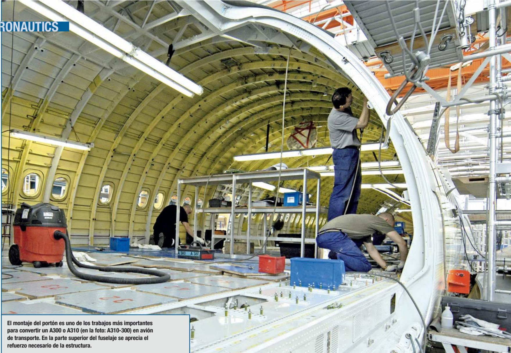
El montaje del portón es uno de los trabajos más importantes para convertir un A300 o A310 (en la foto: A310-300) en avión de transporte. En la parte superior del fuselaje se aprecia el refuerzo necesario de la estructura.
