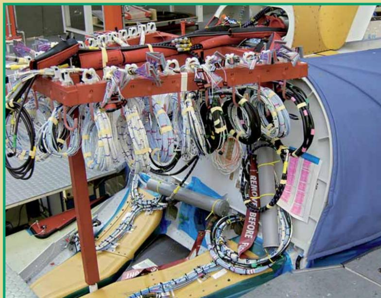
Las partes centrales del fuselaje fabricadas en Augsburg se equipan también en Manching en una cadena de montaje propia. El bastidor auxiliar (naranja) sirve de soporte a los cables que se instalan con posterioridad en la parte delantera del fuselaje y en la carlinga.
