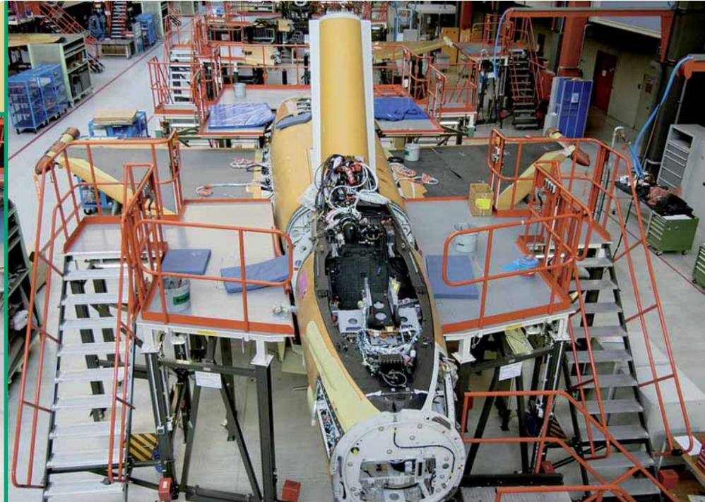
Posición 2, desde arriba: Ya están montadas las alas y el tren de aterrizaje. Se aprecia bien el voluminoso aero freno. Lo fabrica BAE Systems, al igual que la parte dorsal del fuselaje.
