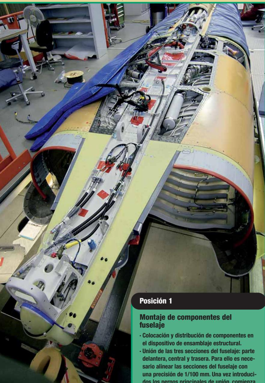
**Posición 1****Montaje de componentes del fuselaje**
