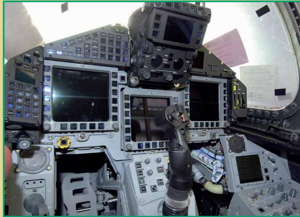
La carlinga de alta tecnología del Eurofighter con tres pantallas multifuncionales en color y un visualizador sobre-cabeza (arriba). Abajo: En la Posición 6 se hacen pruebas exhaustivas de la aviónica instalada ya completamente.
