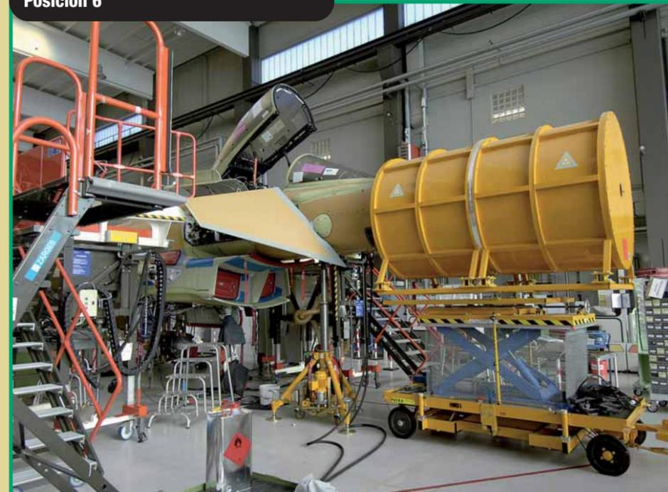
Pruebas del sistema de radar. El radomo está alojado en un compartimento absorbedor de radiación para proteger a los técnicos.
