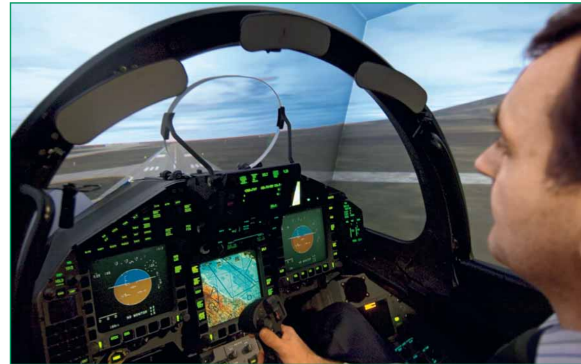
Aproximación en el simulador de cabina. También esta variante simplificada se conecta a través de WAN (Wide Area Network) con un teatro de operaciones simulado para actuar en él a modo de Eurofighter.
