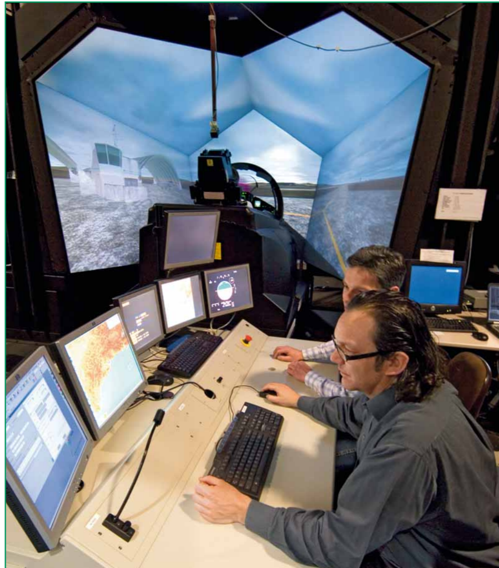
El puesto del monitor en el simulador de cabina. Sirve, en primer lugar, para la formación básica en Eurofighter y la enseñanza de procedimientos de emergencia.
