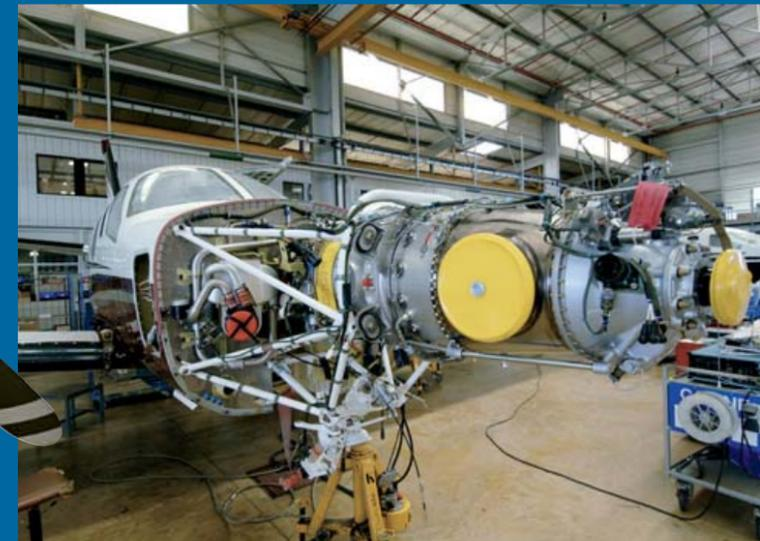
Garantía de la mayor fiabilidad y de escasa sollicitación térmica: La potencia del PT6 se reduce de 1.200 a 700 cv cuando se utiliza en el TBM 700.
