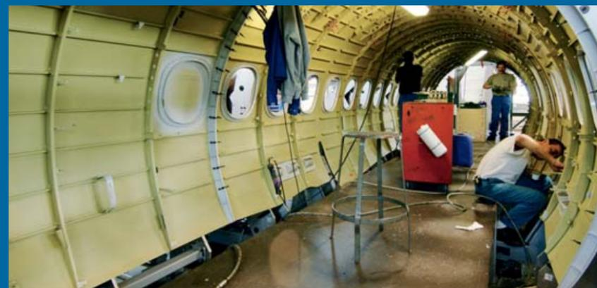
En Tarbes se montan también segmentos del fuselaje de aviones civiles Embraer de los tipos ERJ 170 & 190. Socata produce igualmente carenados de motor para ATR.
