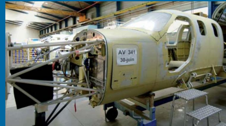
Fuselaje casi completo con la bancada del motor. El mamparo ignífugo interpuesto entre el motor y la cabina es de titanio. En la foto, un aparato con la puerta opcional para el piloto.
