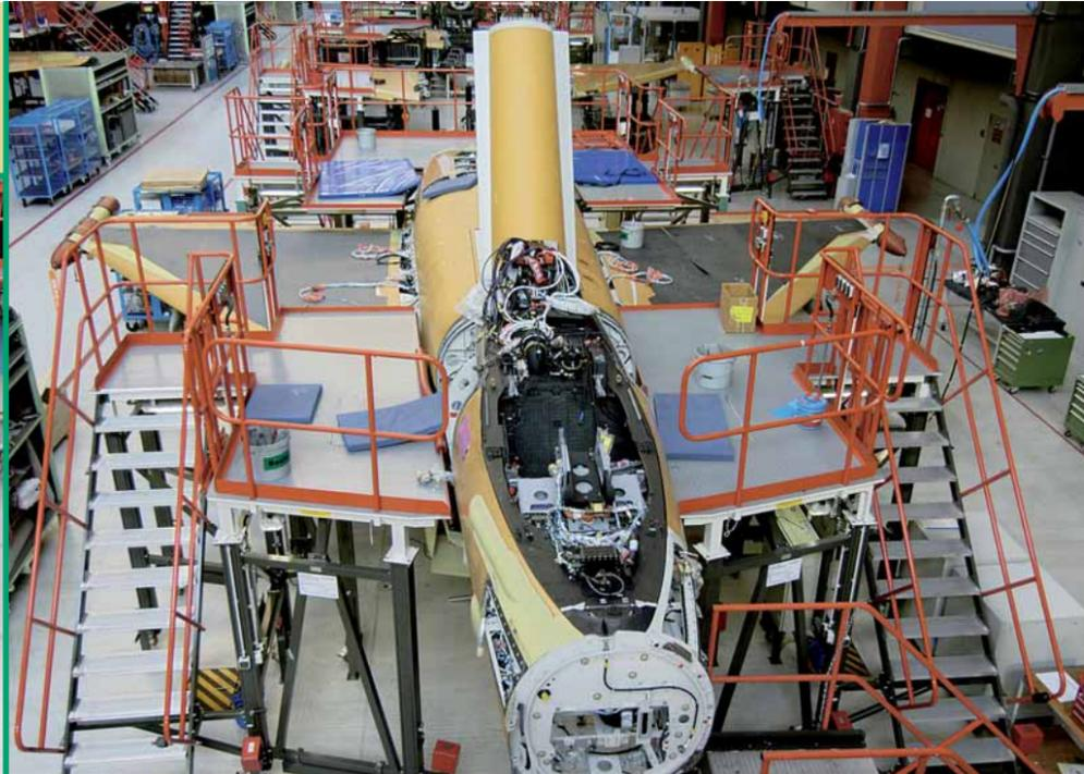
Vue plongeante sur le poste 2 : les ailes et le train d'atterrissage sont montés. L'aérofrein volumineux est bien visible. L'aérofrein et le haut du fuselage sont fabriqués par BAE Systems
