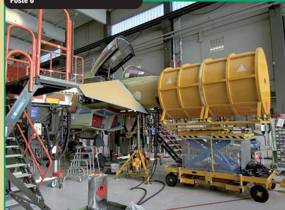
Test du système radar. Une chambre d'absorption entoure le radôme pour protéger les opérateurs des rayons émis
