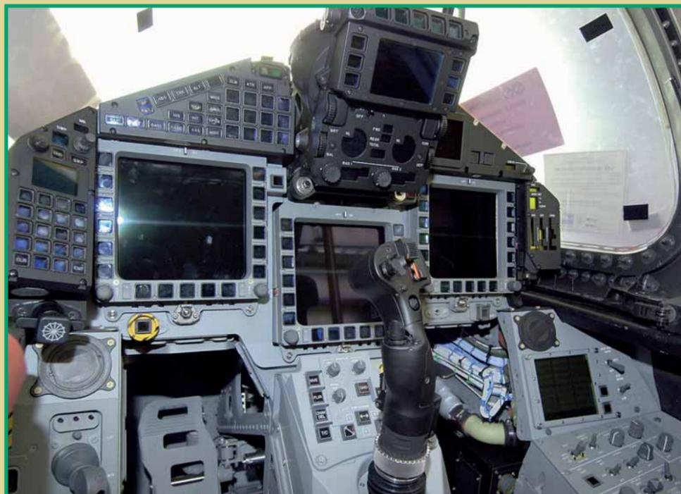
Le cockpit high-tech de l'Eurofighter muni de trois écrans couleurs multifonction et d'une visualisation tête-haute (en haut). En bas : l'avionique complètement installée est soumise à un programme de tests exhaustifs au poste 6
