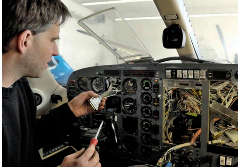
Der Einbau (oben bei Avionik Straubing) dauert 30 bis 40 Stunden, obwohl das Gehäuse des Aspen EFD 1000 in die alten Instrumenten-Ausschnitte passt (rechts außen). Am Rumpf wird das Sensor-Paket mit Not-GPS, Temperaturfühler und Kompass-Magnetometer angebracht (rechts)
