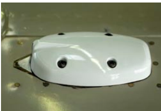
Der Einbau (oben bei Avionik Straubing) dauert 30 bis 40 Stunden, obwohl das Gehäuse des Aspen EFD 1000 in die alten Instrumenten-Ausschnitte passt (rechts außen). Am Rumpf wird das Sensor-Paket mit Not-GPS, Temperaturfühler und Kompass-Magnetometer angebracht (rechts)
