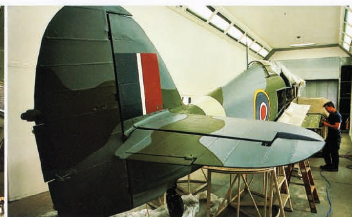
Links: Ein Bomber des französischen Typs Caudron G-4 von 1915 wird komplett restauriert. Rechts: Nach zehn Jahren Arbeit nähert sich die Hawker Hurricane Mk. IIc ihrem zweiten Roll-out – sie wird gerade lackiert
