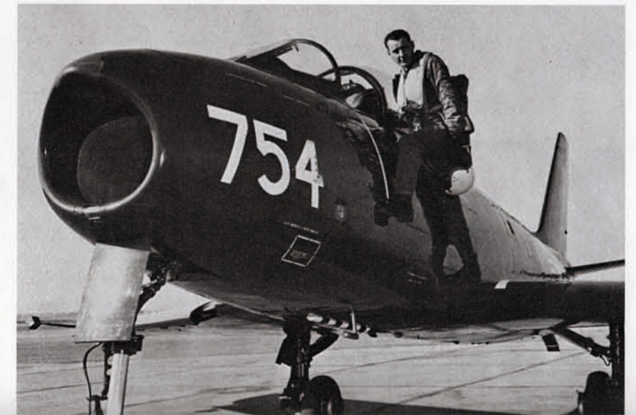
Vor dem Erstflug der FJ-2, einer trägergestützten Version der F-86, die sich vor allem durch den Fanghaken und das verstärkte Bugfahrwerk unterschied
