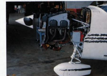
Ein Lycoming IO-360 mit elektronischer Zündung treibt die »R«-Version der 172 an. Die Drehzahl wurde auf 2400 Umdrehungen reduziert, die Verdichtung auf 7,5:1
