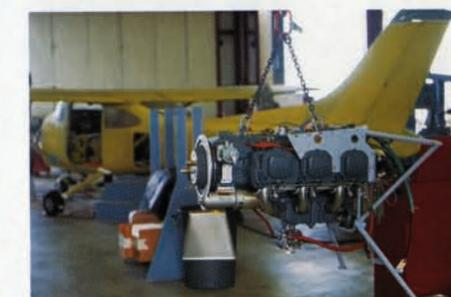
Fertig zum Einbau: der IO-540 der 182. Auch hier kommt eine Version mit gesenkter Kompression zum Einsatz. Die Leistung: 230 PS bei zirka 2500 Umdrehungen
