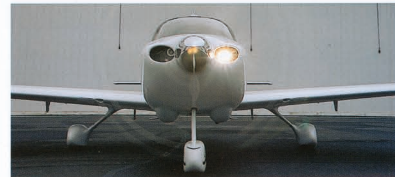
Originelles Detail: der Landescheinwerfer im Lufteinlaß
