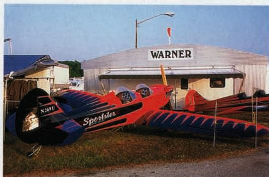
Das neueste Flugzeug von Warner aus Massachusetts ist die »Sportster«, eine vergrößerte Variante der »Space Walker« mit elliptischem Flügel. Die Bauzeit soll nur 600 Stunden betragen, der komplette Schnellbausatz kostet unter 20 000 Dollar
