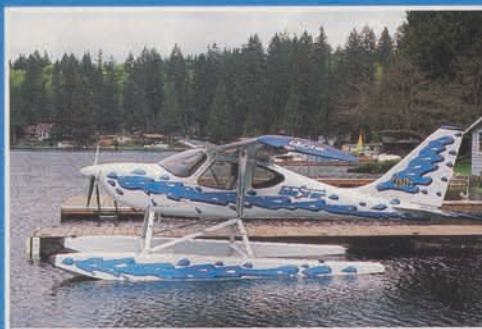
Auch auf dem Wasser zuhause: Nur vier Stunden dauert der Umbau auf die Kunststoffschwimmer von Aerocet
