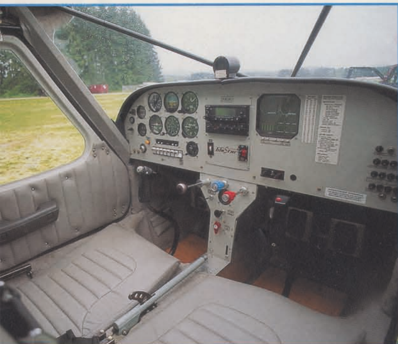
Das Standard-Cockpit der Vorführmaschine macht deutlich, wieviel Platz das Panel für Zusatzausrüstungen bietet. Die Landeklappen werden klassisch über einen mechanischen Griff betätigt, für genaues Dosieren der Auftriebshilfen optimal
