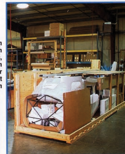
Die beiden Hälften des Rumpfes, kurz nachdem sie aus der Form befreit wurden
