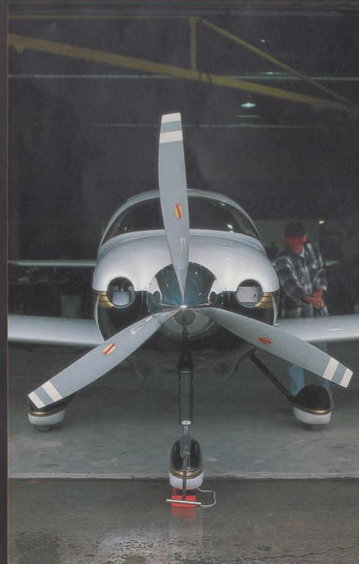
300 PS bei 2700 Umdrehungen leistet der Continental IO-550, der momentan noch nicht schalldämpft ist. Mit über 1,95 Meter Durchmesser etwas kleiner als bei der Lancair ES ist der CS-Prop von Hartzell. Für die Serie denkt man bei Lancair aber auch an Drei- und Vierblatt-Luftschauben von Mühlbauer
