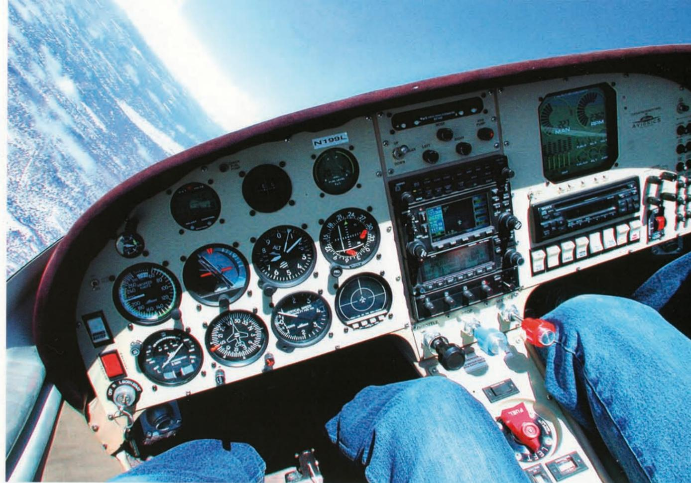
60 Grad bank bei 460 Stundenkilometern. 220 indicated oder 250 Knoten TAS in 7000 Fuß sind noch nicht das Maximum. Oben die Standardinstrumentierung mit GPS Garmin 430. Links: Komplettes Glascockpit von Sierra Flight Systems
