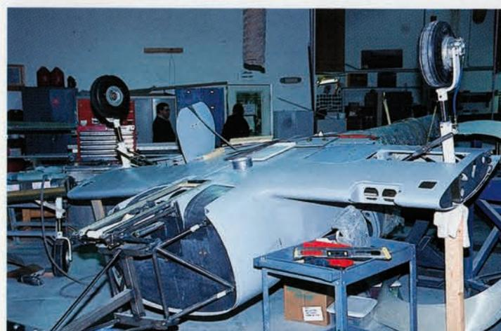
Im »Builder Assist«-Programm führen die Käufer wichtige Arbeiten wie den Einbau des Fahrwerks oder den Bau des Leitwerks unter Anlei- tung von Spezialisten selbst aus. Letzter Schritt, bevor es in der heimischen Garage weiter geht: das endgültige Verschließen der Flächen
