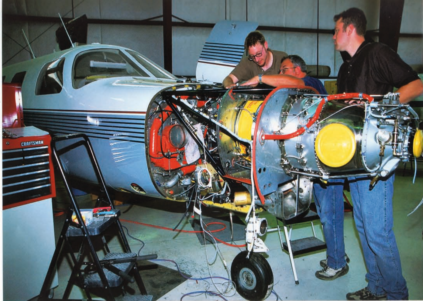
Die Pratt & Whitney PT-6A-34 in der JetPROP DLX ist von 750 auf 560 PS gedrosselt. Bei einer TBO von 4000 Stunden sinken die Betriebskosten pro Stunde unter Kolbenmotor-Niveau
