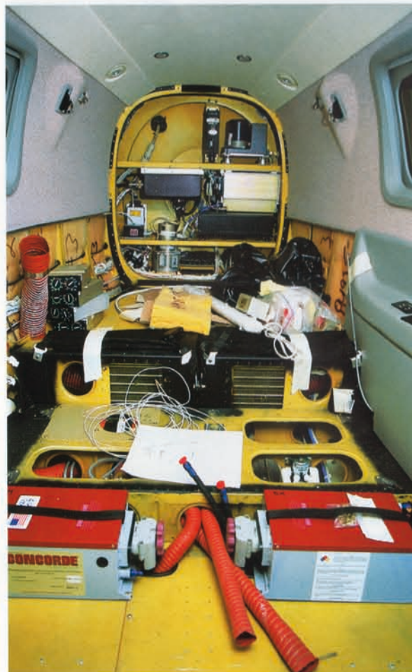
Für den Umbau wird die Maschine weitgehend zerlegt. Vorn die Batterien, hinten die Modifikation der Kabinenheizung, die mit einem typischen Manko der PA-46 aufräumt: kalte Füße
