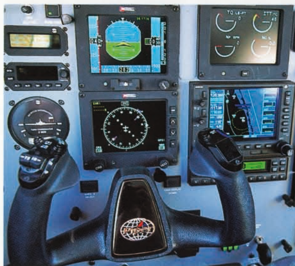
Das Primary Flight Display (oben) zeigt alle für den IFR-Flug notwendigen Infos an, bei Bedarf auch einen Flight Director
