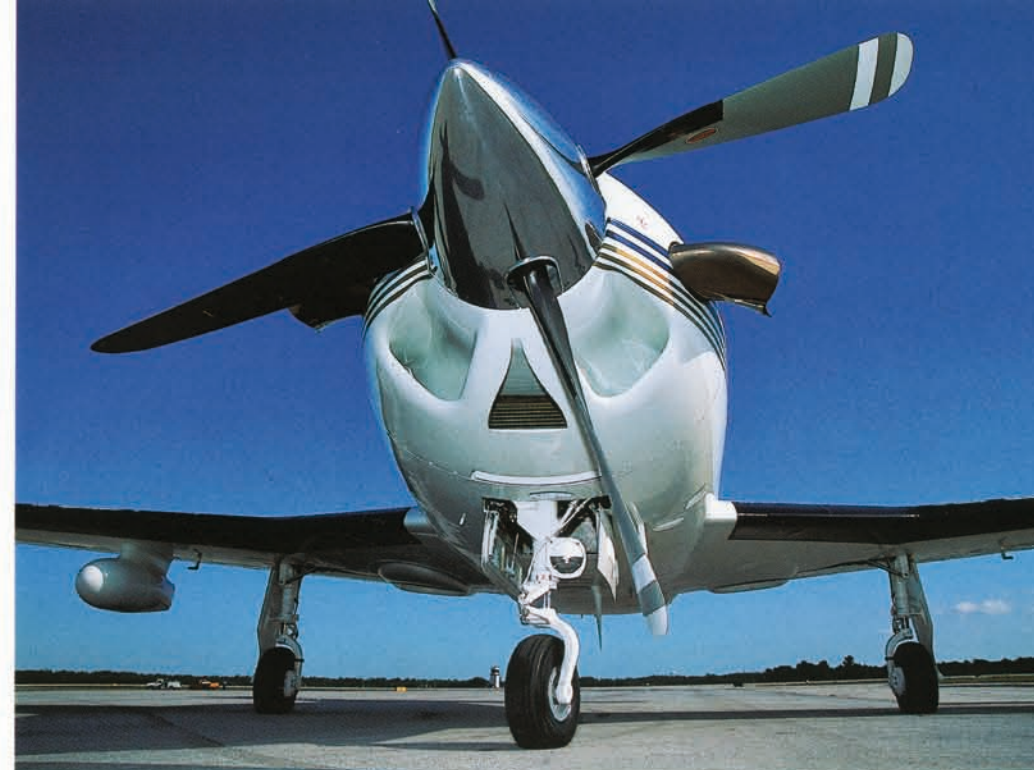
Zwei NACA-Lufteinlässe für die Triebwerksluft, einer in der Mitte für den Ölkühler
