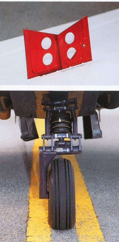
Die Speed Brakes (oben) sind serienmäßig und elektrisch betätigt. Die Encore hat das stabilere und eingefahren vollverkleidete Fahrwerk der »Ovation« und »Bravo«
