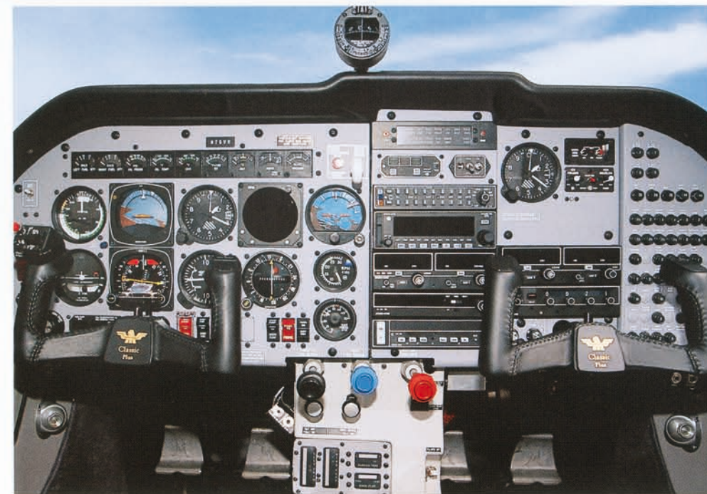
Mit der »Classic Plus«-Ausstattung kostet die Encore fast 400 000 Dollar. Mit Stormscope, HSI und Flight Director ist die Encore allerdings auch ein vollwertiger »Personal Airliner«. Optional: Der zweite Horizont und Höhenmesser
