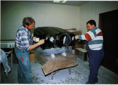
Die neue Cowling aus CFK im Bau
