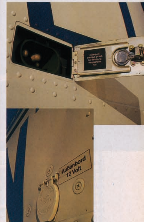
Veränderungen vor allem an Details: Anstelle der einfachen Positionslampen gibt es jetzt Strobe Lights, der praktische Außenbordanschluß veränderte sich in Position und Aussehen. Das Fahrwerk der Warrior III hat keine strömungsgünstigen Radverkleidungen mehr
