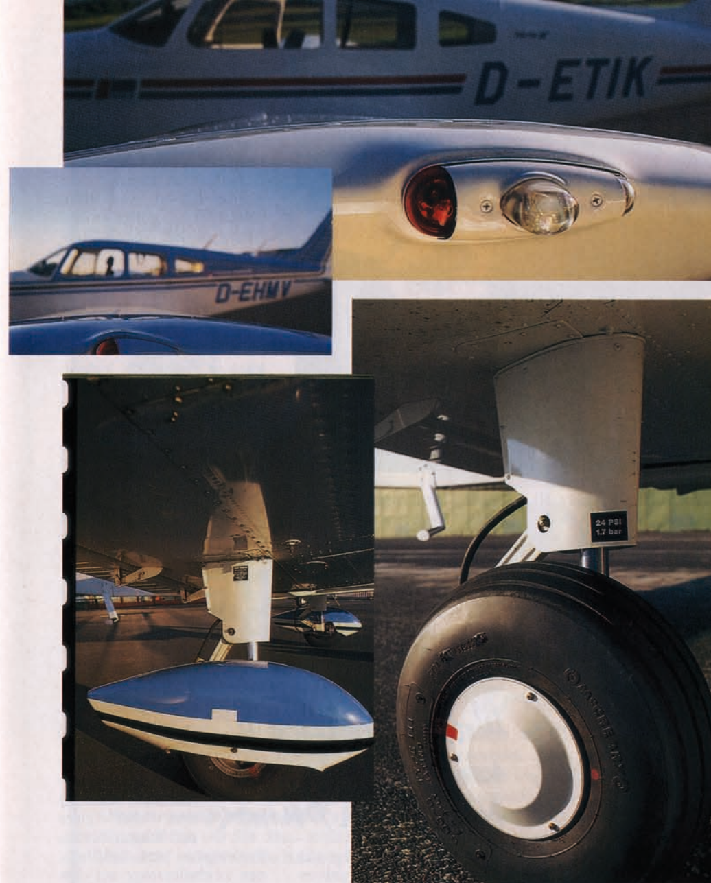
Veränderungen vor allem an Details: Anstelle der einfachen Positionslampen gibt es jetzt Strobe Lights, der praktische Außenbordanschluß veränderte sich in Position und Aussehen. Das Fahrwerk der Warrior III hat keine strömungsgünstigen Radverkleidungen mehr
