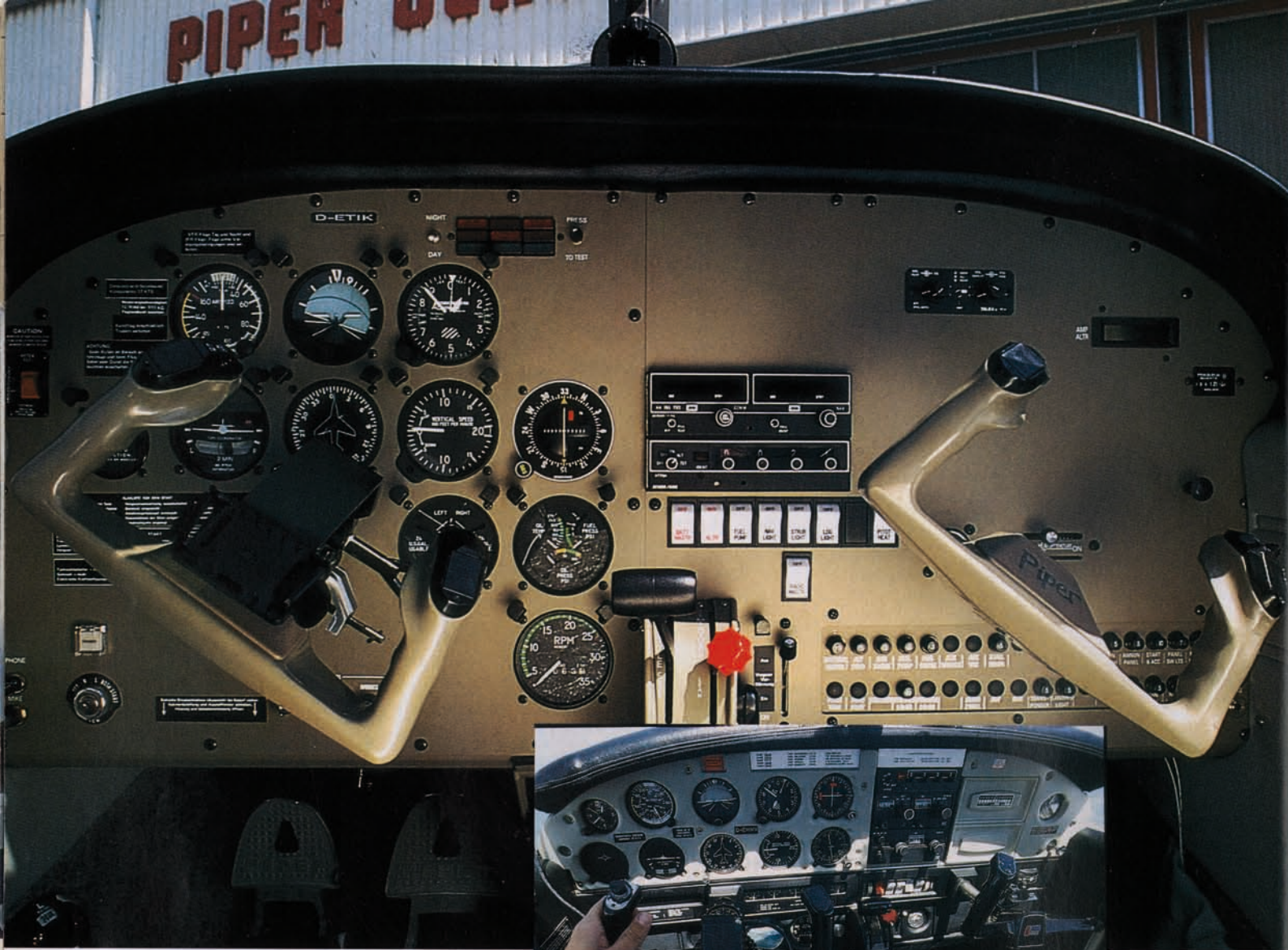
Das neue Metall-Panel: mit Systemausfall-Warntafel, digitalem Amperemeter und neuen Kombi-Instrumenten. Unten: Die alte Version der Cherokee Warrior und der Warrior II
