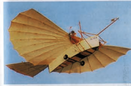
Der Weißkopf-Nachbau flog 1998 – allerdings mit modernen UL-Motoren und Propellern
