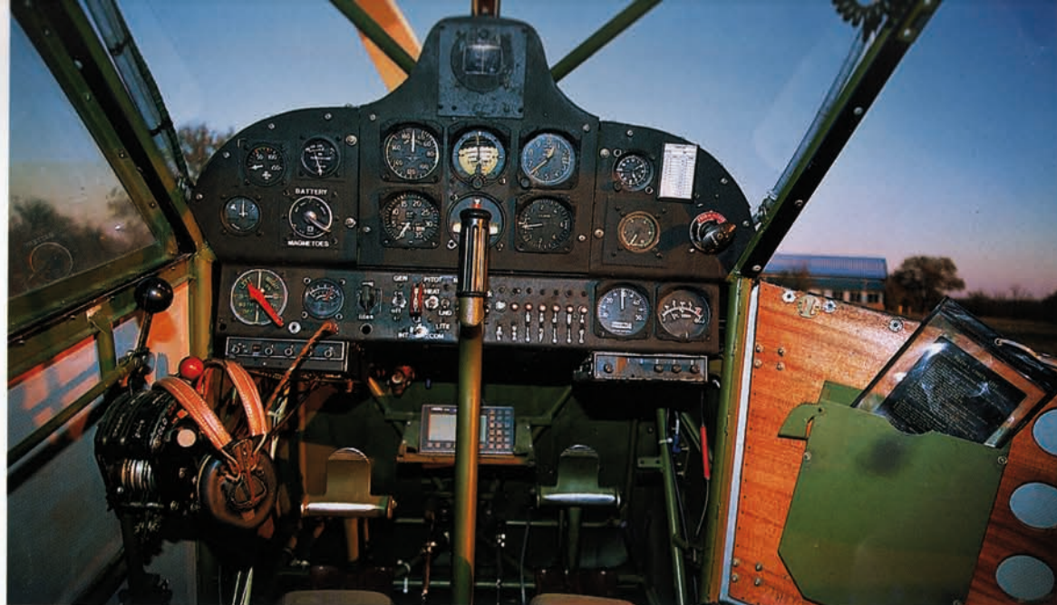
Echtes Oldtimer-Ambiente zum Preis etwas zweifelhafter Detaillösungen: Dass der Mixerhebel ganz vorn auf »idle cut-off« steht – daran muss man sich erst gewöhnen!
