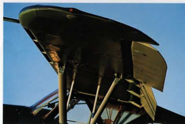
Echtes STOL-Flugzeug: Die L-5 hat Vorflügel und absenkbare Querruder
