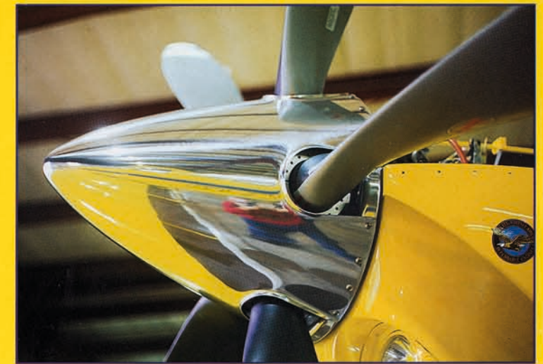
Ungewöhnlich für einmotorige Flugzeuge: Durch den mächtigen Fünfblattprop ist der Air Tractor selbst in seiner stärksten Ausführung erstaunlich leise
