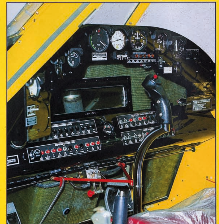
Im Cockpit dominieren nicht die Fluglage- oder Triebwerksanzeigen, sondern eindeutig die Bedienelemente der Sprühanlage. Typische Anzeige des Höhenmessers: 6 Fuß. Unten: Massiv wie ein Unimog, der Air Tractor
