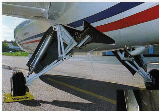
Die Tage dieser eleganten Fahrwerkslösung à la Extra 400 sind gezählt: Wegen der zu schmalen Spur ist die Richtungsstabilität nicht optimal
