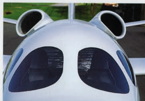
Der Steg zwischen den Cockpitscheiben wird in der Serienproduktion schmaler werden, um so die Sicht zu verbessern
