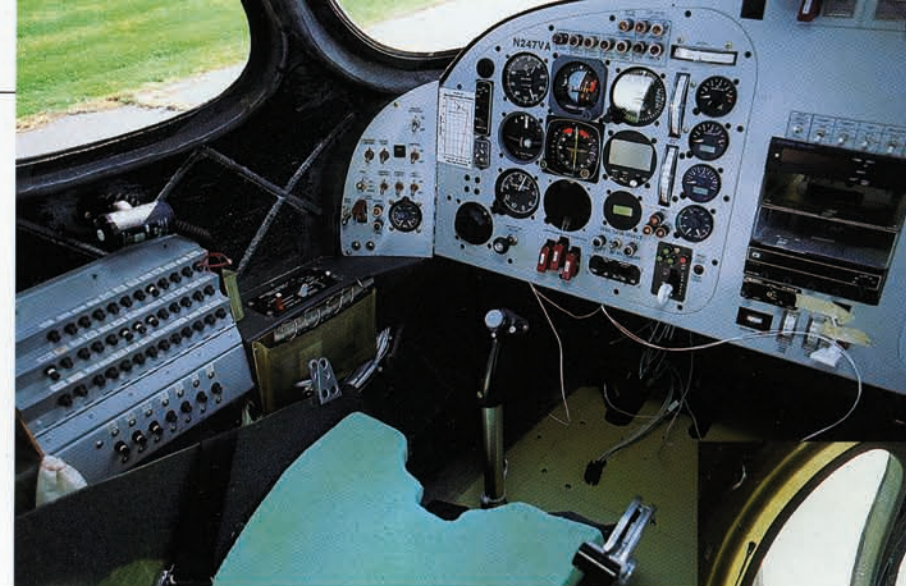
Prototypen-Provisorium: Natürlich wird auch die Vantage mit den in dieser Klasse üblichen Yokes und nicht mit einem Knüppel gesteuert werden
