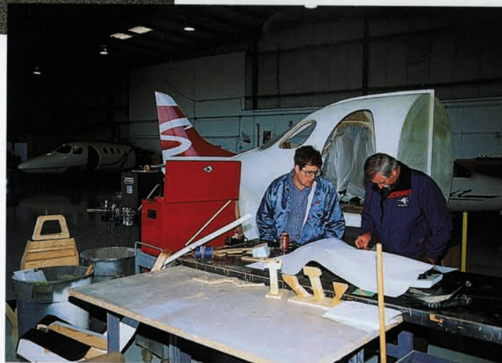
Auch an der Innenausstattung sind die Arbeiten in vollem Gange. Die High-Tech-Sitze werden von der Firma Fischer aus dem bayerischen Landshut entwickelt
