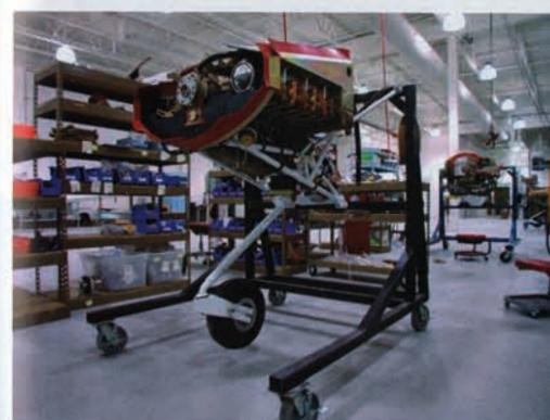
**I**n einer eigenen Abteilung wird die Einheit Motor, Motorträger und Bugfahrwerk komplettiert. Das Management ist permanent weiter auf der Suche nach Wegen, die Bauzeit zu verkürzen – und damit das Produkt profitabler zu machen
