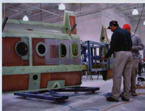
**D**ie Tragflächen werden auf der Helling mit einander verbunden, bevor sie bei der »Hochzeit« mit dem Rumpf zusammenkommen. Hier gut zu sehen: die üppig dimensionierten Wartungsdeckel auf der Unterseite der Flügel
