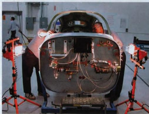
**E**in großer Teil der Arbeit fließt – neben dem Bau der Tragflächen – in die Installation von Leitungen und Elektrik im Rumpf. Das Brandschott aus Stahl ist hier bereits eingebaut, einige der Triebwerks-Aggregate sind schon daran befestigt
