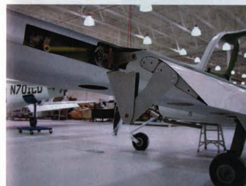
**H**öhenruder, Querruder, Seitenruder und Landeklappen sind sowohl bei der SR-20 wie auch bei der SR-22 aus Metall. Die Anlenkung der Fowler-Klappen ist gut zu sehen, da die Querruder noch nicht montiert sind
