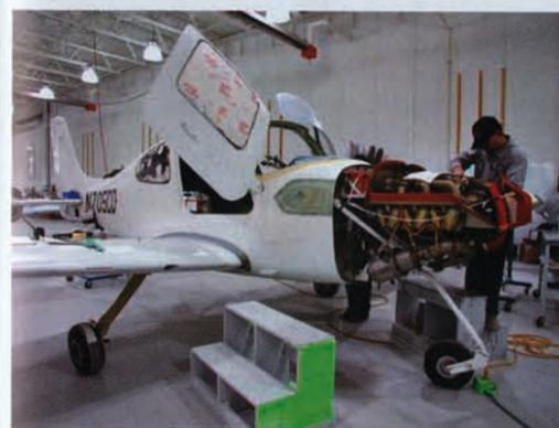
**J**etzt sind Antrieb und Zelle verbunden. Vor der Lackierung sind die dünn überlaminieren Schächte des Rettungssystems zu erkennen. Wird die Rakete ausgelöst, reißen die Kevlar-Seile die Abdeckung auf – dann hängt die Maschine am Schirm
