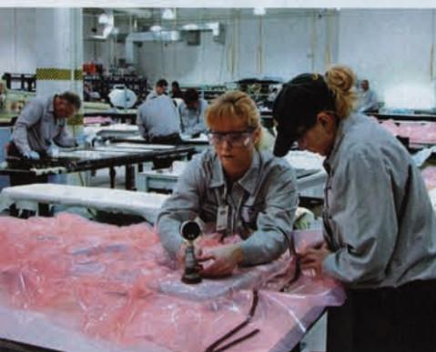
**A**us gehartztem Gewebe werden, fast wie in einer Schneiderei, in der Composite-Abteilung die Teile für alle Komponenten des Flugzeugs zugeschnitten. Mit der Form wird das Material dann in Folie verpackt und im Autoklav-Verfahren ausgehärtet
