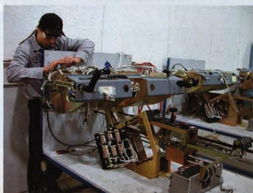
**F**ummelarbeit auch hier. Obwohl der Zusammenbau des Panels – komplett mit einem großen Teil der Steuerung, Elektrik und Triebwerksbedienung – außerhalb des Flugzeugs stattfindet, stecken in dieser Baugruppe viele Arbeitsstunden
