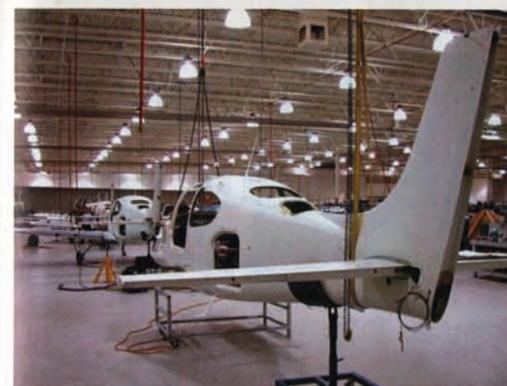
**G**roßzügig und hell präsentiert sich die Endmontagehalle. Fast wie auf einem Fließband werden die Maschinen Schritt für Schritt endmontiert. Auffällig ist, wie leise und behaglich eine Produktionsstätte sein kann – in der nicht genietet wird
