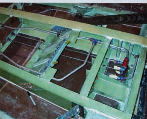
**B**lick ins Innere einer SR-22-Tragfläche. Gut zu erkennen sind die Spritleitungen und Ventile in den »nassen« Tanks. Unten bereits angeschraubt: die Aluminium-Führungen für die Fowler-Landeklappen
