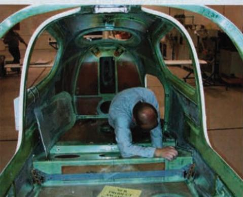
**C**irrus baut Tragflächen und Rumpf fast komplett aus GFK. Nur wenige Teile sind aus Kohlefaser-verstärktem Kunststoff, beispielsweise der Wartungsdeckel auf der Cowling. Dieser wäre aus GFK nicht steif genug und könnte sich im Flug verziehen
