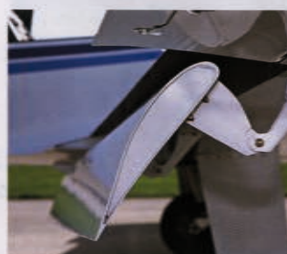
Die Landeklappen bestehen, wie die Ruder, aus GFK
